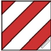
Cuando la **carga sobresalga por la parte posterior del vehículo** deberá colocarse la señal V-20 (panel para cargas que sobresalen) en el extremo posterior de la carga, de manera que quede constantemente perpendicular al eje del vehículo.
