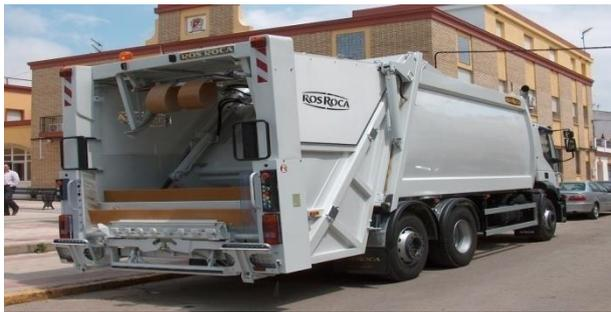
El protector lateral no aumentará la anchura total del vehículo y la parte principal de su superficie externa no se adentrará más de 12 centímetros con respecto al plano más externo del vehículo (su anchura máxima).
