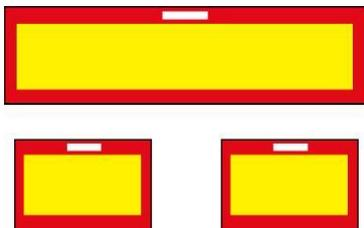
Los autobuses, los autobuses articulados y los autobuses con remolque cuya longitud rebase los 12 metros deberá llevar, en su parte posterior y centrada con respecto al eje del vehículo la **señal V-6**, consistente en una placa de 1.300 milímetros de longitud y 250 milímetros de altura con el fondo de color amarillo reflectante y borde rojo fluorescente de 40 milímetros.
