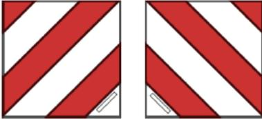
Cuando la carga sobresalga longitudinalmente por toda la anchura de la parte posterior del vehículo, se colocarán transversalmente dos paneles de señalización, cada uno en un extremo de la carga o de la anchura del material que sobresalga. Ambos paneles deberán colocarse de tal manera que formen una geometría de "v" invertida, con franjas alternas rojas y blancas.
