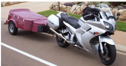
De acuerdo con lo previsto en el artículo 12 del Reglamento General de Circulación, las motocicletas, los vehículos de tres ruedas, los ciclomotores y los ciclos y bicicletas podrán arrastrar un remolque o semirremolque, siempre que su masa no supere el 50 por ciento de la masa en vacío del vehículo tractor y se cumplan las siguientes condiciones:
