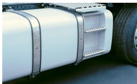
Fig. 4 Depósito y escaleras
