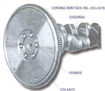
Fig. 9 Volante de inercia
