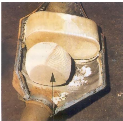
Fig. 11 Desgaste y rotura del catalizador
