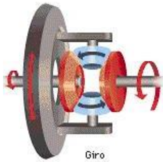
Fig. 26 Un planetario gira más que otro, a costa del giro que le transmiten los satélites
