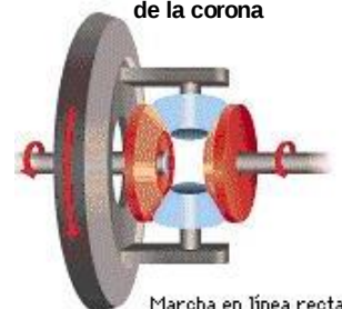
Fig. 25 Corona y los dos planetarios giran lo mismo
