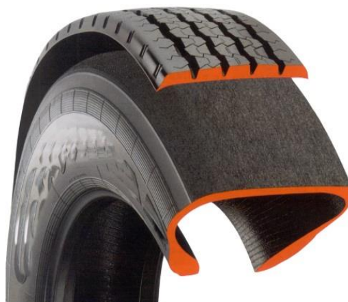
Fig. 17 Aplicación de una nueva banda
